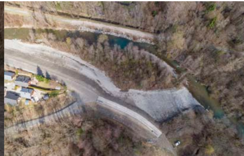
Secteur du Pré de l'Arche : un déversoir de sécurité permettra, en cas de crue intense, de réduire le débit de la rivière. L'eau ira inonder la forêt, les habitations étant protégées par un merlon aménagé cet hiver (2).
